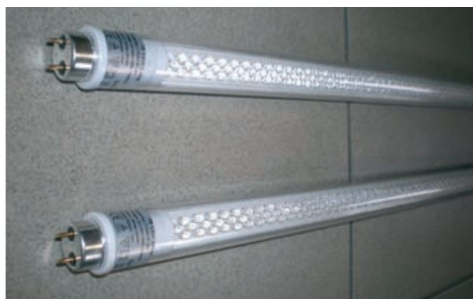
Fot. 1. W środku rur są widoczne trzy rzędy z diodami
