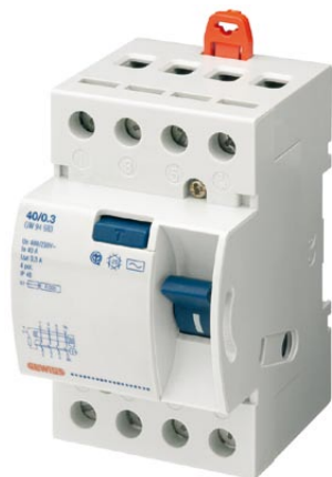
Fot. 1. Wyłącznik różnicowoprądowy 4-biegunowy 40 A, 300 mA, o szerokości 3 modułów (52,5 mm)
